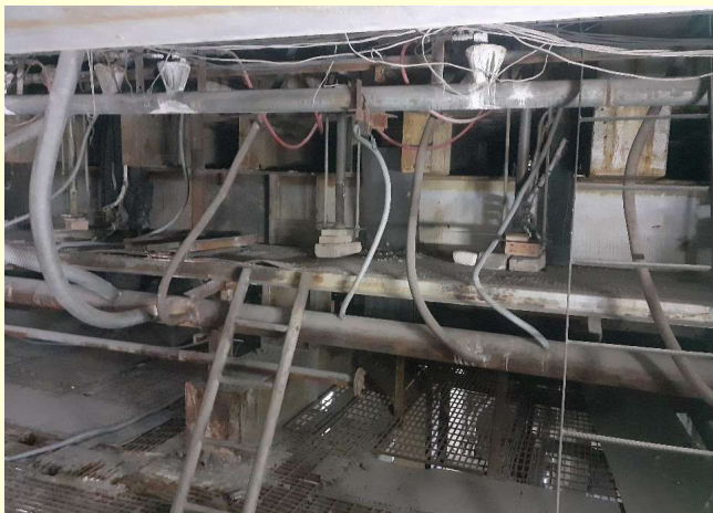
चित्रा 1: कांच पिघलने में इलेक्ट्रोड स्थिति निर्धारण
