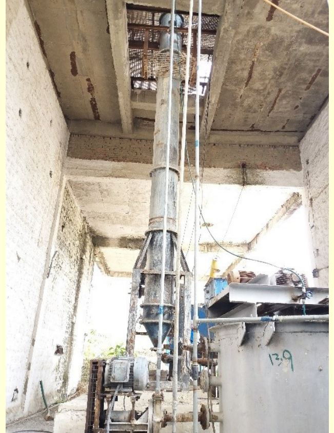
चित्र 1: 25 टन प्रति दिन क्षमता एनएमएल फ्लोटेशन कॉलम (0.5 मीटर व्यास) मेसर्स वेदाम कैल्सीमिन प्राइवेट लिमिटेड में स्थापित। लिमिटेड, तेलंगाना चूना पत्थर के लाभकारी के लिए।
