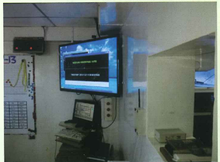
चित्र 5 : नियंत्रण कक्ष में नमी संवेदक के द्वारा वायरलेस तरीके से प्रसारित नमी मूल्यों का प्रदर्शन
