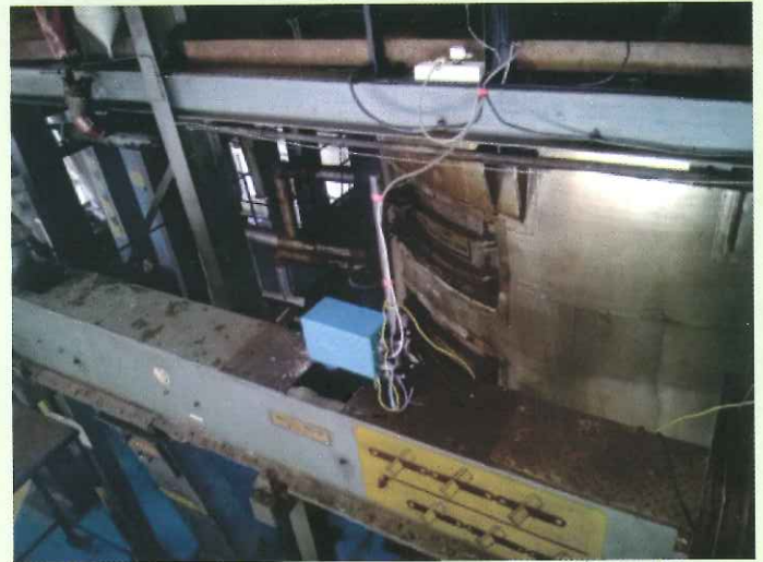
चित्र 4 : इन-सिटु में स्थापित एनआईआर नमी संवेदक
